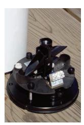
Lleva incorporados tornillos de nivelación y nivel para un ajuste fácil y preciso en campo. Una vez medidas, las precipitaciones se descargan a través de un tubo de recogida para poder verificar la precipitación total.
